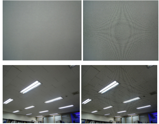
(그림 16) Nikon COOLPIX S640의 그레이 카드, 실제 장면의 원본과 검출 맵을 이용한 차분 값의 보간 패턴 노이즈 이미지
