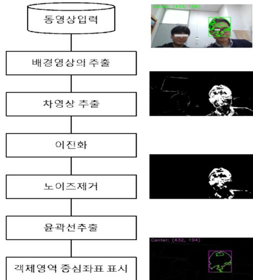
(그림 1) 소프트웨어기반 객체 움직임 검출 알고리즘 (Figure 1) Software-based object motion detection algorithm
