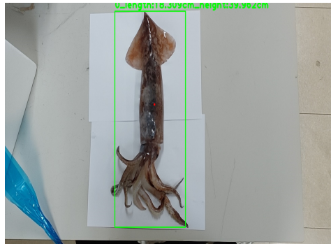
(그림 12) 오징어 인식 및 체장·체고 측정 결과
