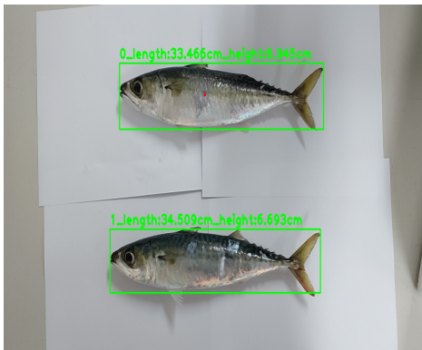
(그림 10) 고등어 인식 및 체장·체고 측정 결과
