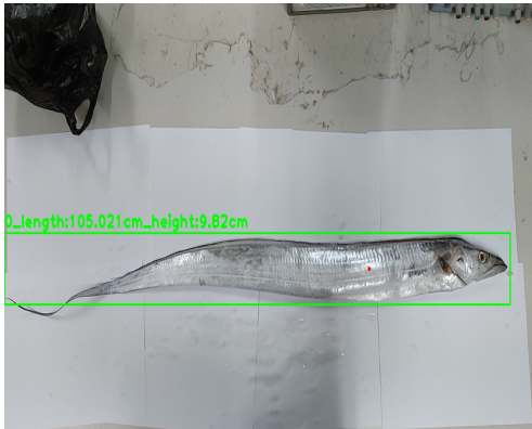
(그림 14) 갈치 인식 및 체장·체고 측정 결과 (Figure 14) cutlassfish recognition and measurement results of length and height
