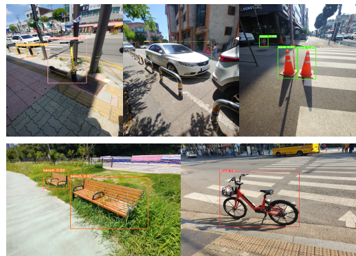
(그림 2) 장애물 객체 인식 (Figure 2) Obstacle-Related Object Recognitions
