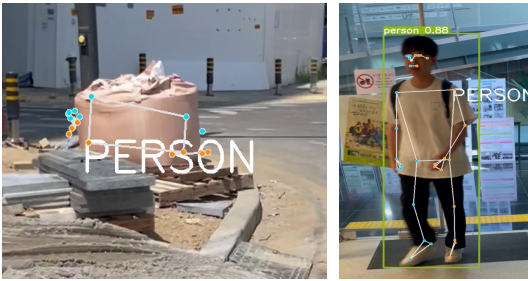
(그림 3) mediapipe 오탐 예시(왼쪽), 융합 알고리즘 기반 모션 인식(오른쪽)
