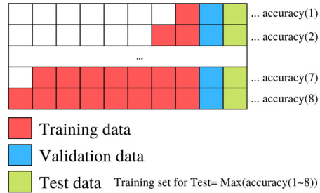
(그림 2) 역순 워크 포워드 검증 방법론 (Figure 2) Reverse Walk-forward Validation
