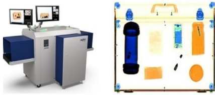
(그림 1) X-ray 위험물 검사방식
