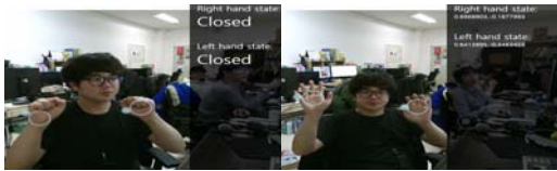
(그림 5) 키넥트 SDK를 사용한 손 감지 (Figure 5) Hand detection result using Kinect SDK
