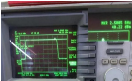
(그림 10) drone 재밍 2.4Ghz 모듈 테스트 화면 (Figure 10) drone jamming 2.4Ghz module test screen
