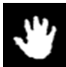
(그림 3) 임계값 설정을 통한 손 영역 분리 (Figure 3) Detection of hand region by the threshold
